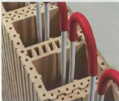
Bei der Wienerberger Ziegelwand-Temperierung werden rund einen Meter breite, warmwasserführende Pipelife-Aluminiumverbund-Rohrmodule in ein Ziegelmauerwerk gesetzt
